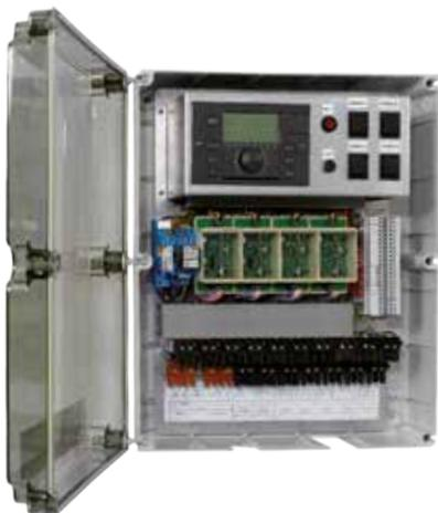
È racchiuso in una cassetta provvista di coperchio trasparente. Il tutto è classificato in IP65. Il quadro è completamente cablato e le connessioni ai moduli termici a condensazione sono già predisposte. La centralina, inclusa all'interno, gestisce il sistema in cascata con programmazione casuale delle accensioni; inoltre la stessa è a tutti gli effetti una centralina climatica con svariate funzioni aggiuntive, le principali sono:
